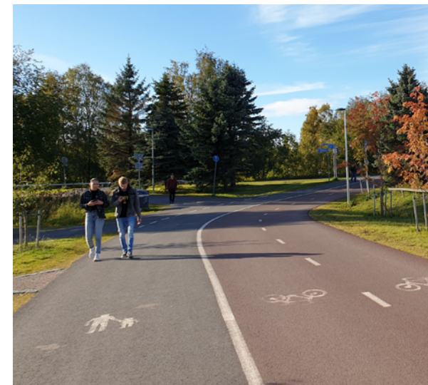
Kuva 17. Baanoilla käytetään punaista päällystettyä, pyöräliikenteen suuntia erottavaa keskiviivaa ja noppakiviraitaa jalankulun ja pyöräilyn välissä (kuva Oulusta).
