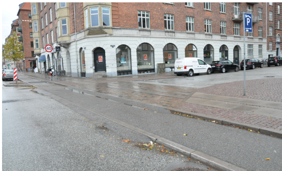
Kuva 22. Jalankulku- ja pyörätien rakenteen jatkaminen korotettuna sivukadun ajoradan yli antaa autoilijalle vahvan visuaalisen viestin väistämismellollisuudesta ja on miellyttävä kävelijöille ja pyöräilijöille (kuva Kööpenhaminasta).
